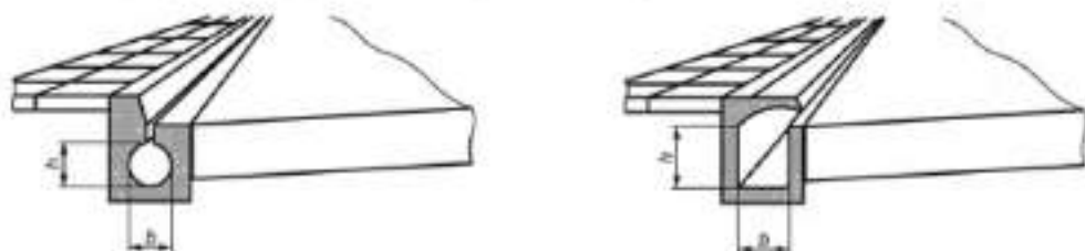
h, b — внутренние размеры (смазываемый периметр)
